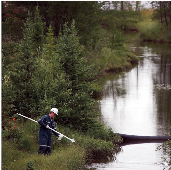
Prélèvement d'échantillons d'eau à Key Lake dans le cadre du système de gestion environnementale.
