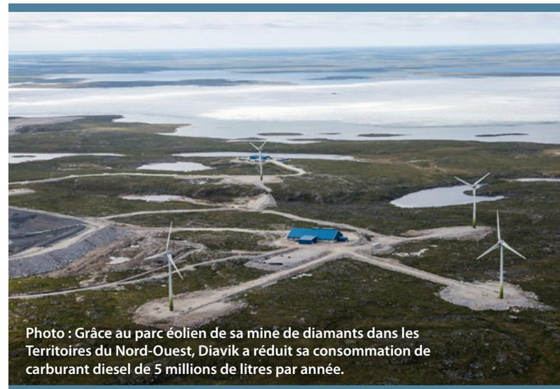
Photo : Grâce au parc éolien de sa mine de diamants dans les Territoires du Nord-Ouest, Diavik a réduit sa consommation de carburant diesel de 5 millions de litres par année.
