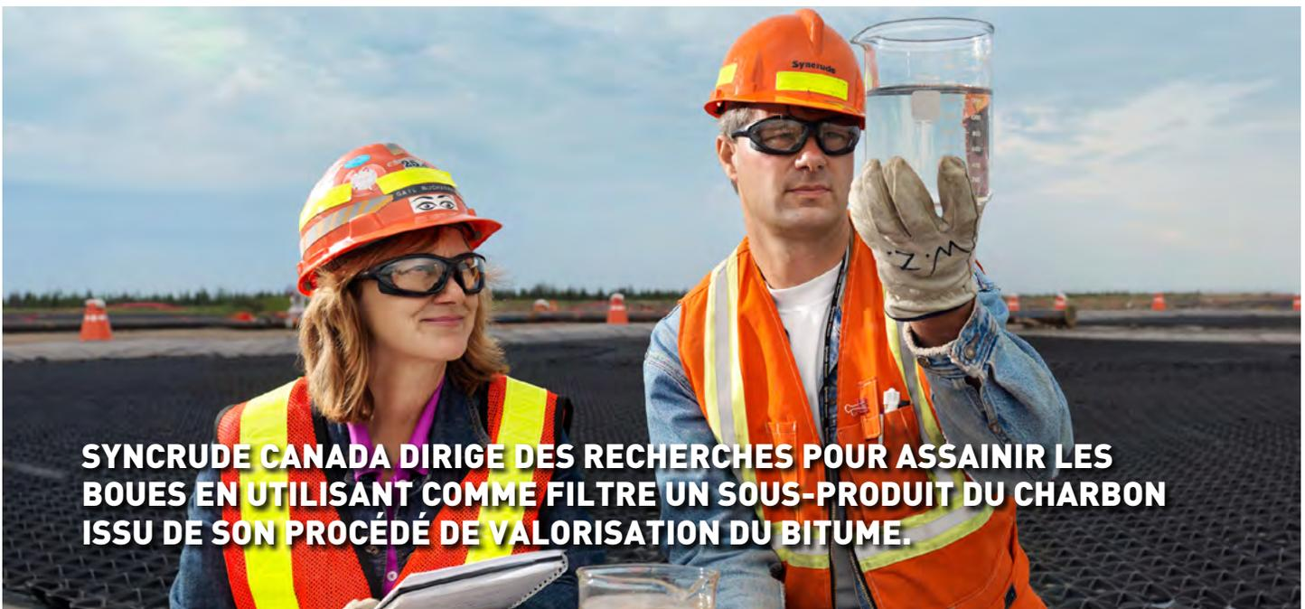
**SYNCRUDE CANADA DIRIGE DES RECHERCHES POUR ASSAINIR LES BOUES EN UTILISANT COMME FILTRE UN SOUS-PRODUIT DU CHARBON ISSU DE SON PROCÉDÉ DE VALORISATION DU BITUME.**
